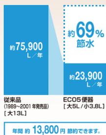
大切な水をムダなく賢く節約します。大洗浄5L、小洗浄3.8Lの「超節水ECO5トイレ」。従来品\*(大13L)と比べ約69%の節水を実現。 **ECO5**
